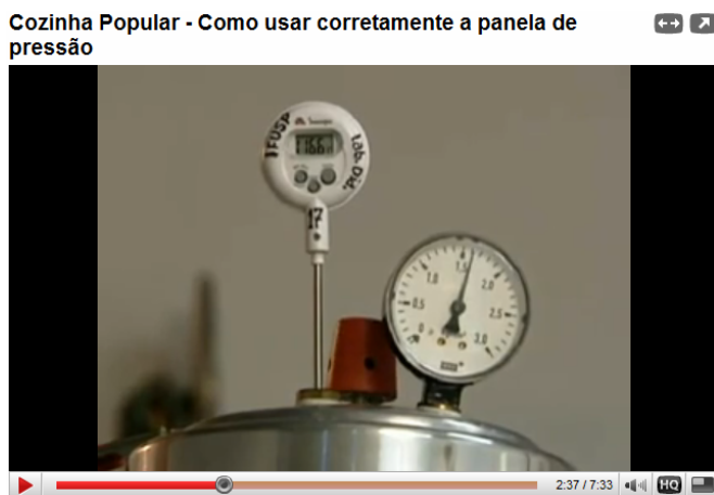
Figura 7. Indicações de temperatura (116,9 °C) e pressão (1,6 atm) no interior da panela de pressão durante a mudança de fase.
