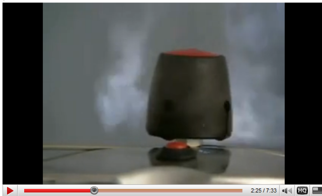
Figura 6. Vapor saindo pela válvula de segurança da panela de pressão devido à vaporização da água.
