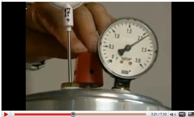
Figura 10. Pressão no interior da panela de pressão com o pino pressionado para baixo durante a vaporização (aumento de pressão para aproximadamente 2,1 atm).
