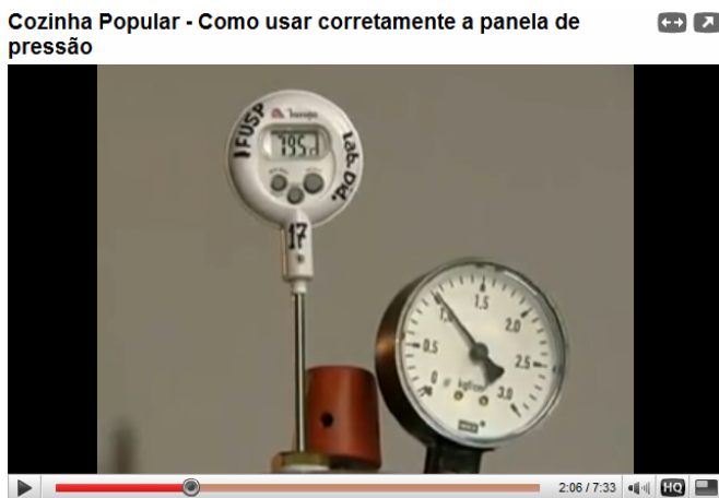
Figura 4. Termômetro e manômetro conectados à panela de pressão.
