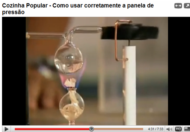
Figura 13. Vapor sendo liberado durante a mudança de fase e realizando trabalho, como na panela de pressão funcionando normalmente.
