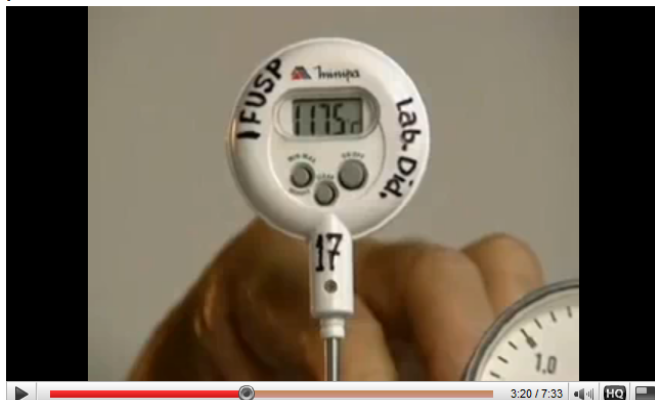
Figura 11. Temperatura no interior da panela de pressão com o pino pressionado para baixo durante a vaporização (aumento de temperatura para 117,5 °C).
