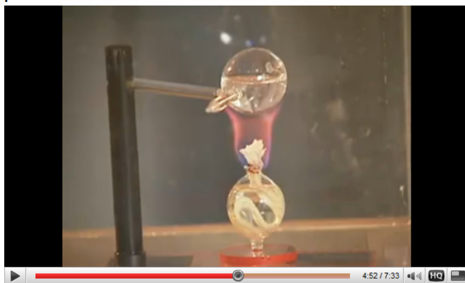
Figura 15. Água líquida à alta temperatura dentro do recipiente. Como a pressão é grande no interior do balão, a temperatura de mudança de fase aumenta muito.
