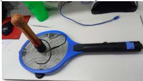
Figura 1 – Registro do resultado da bobina após a conclusão da montagem.
