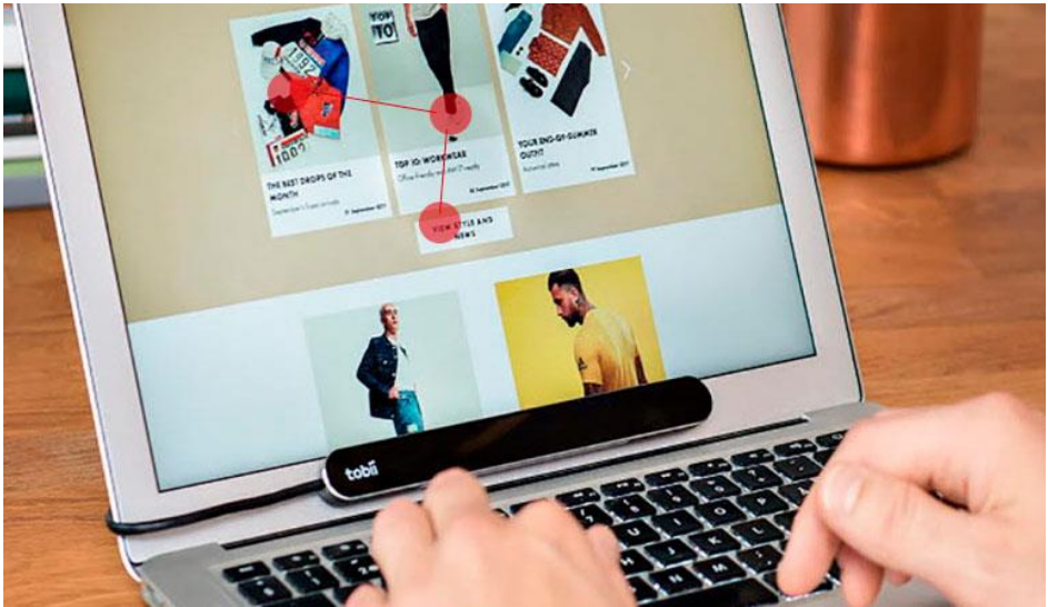
Figura 1: Aparelho de mapeamento do foco da visão (Eye Tracker Tobii pro Nano) vinculado ao computador
